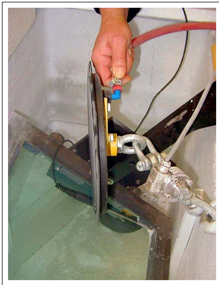
La photo montre qu'à -30,8\text{ °C} , la ventouse est congelée (rigide) et non opérationnelle.
