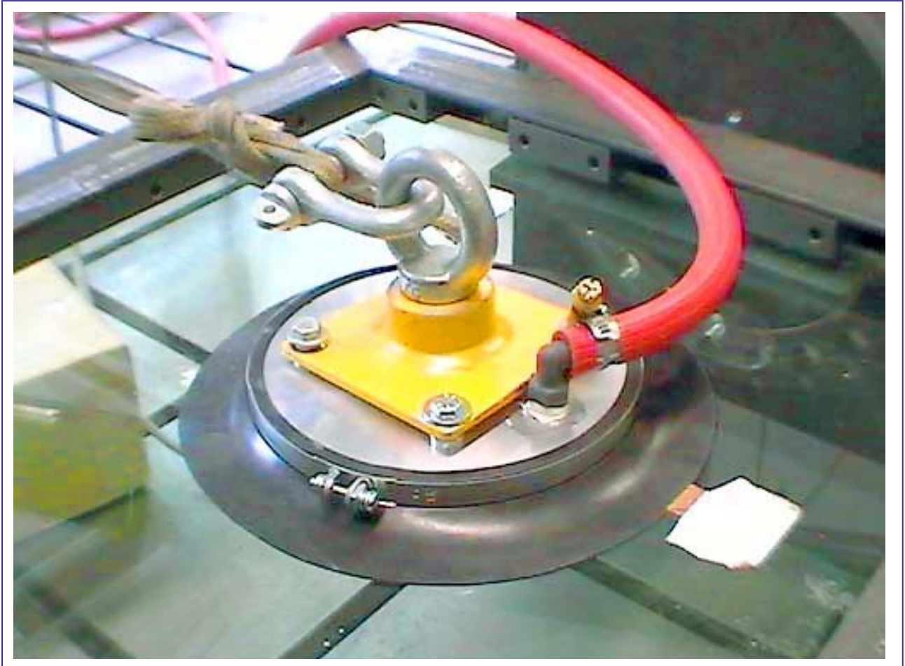
Figure 4 : ventouse Euro-Tech 540/82, à droite au niveau de la lèvres en caoutchouc se trouve le repère de référence permettant de détecter le mouvement de glissement.
